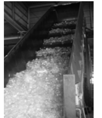
手選別した後、コンベヤーで運ばれます
