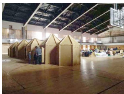
名古屋工業大が研究開発した段ボール製の屋内用インスタントハウス
