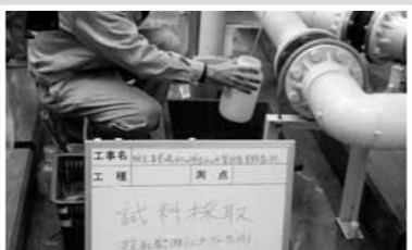
▲汚水の水質検査 企業などの特定事業場から排出される汚水の水質検査
